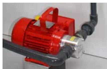
Сам процесс кормления осуществляется при помощи роторного насоса с регулируемым числом оборотов.
