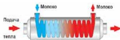
Чтобы скормить поросятам наиболее оптимальный корм, приготовление кормового супа выполняется терморегулируемо, а именно, кормовая смесь подогревается постоянно до идеальной температуры с помощью высокоэффективного теплообменника.
