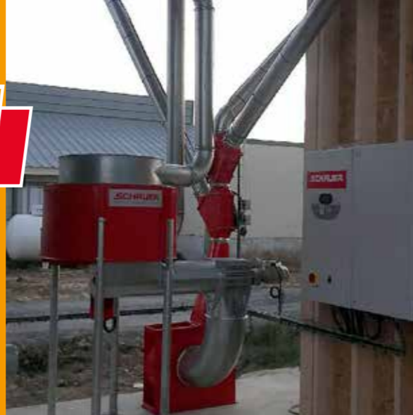
Передаточное устройство с основным вентилятором и переключателем клапанов
