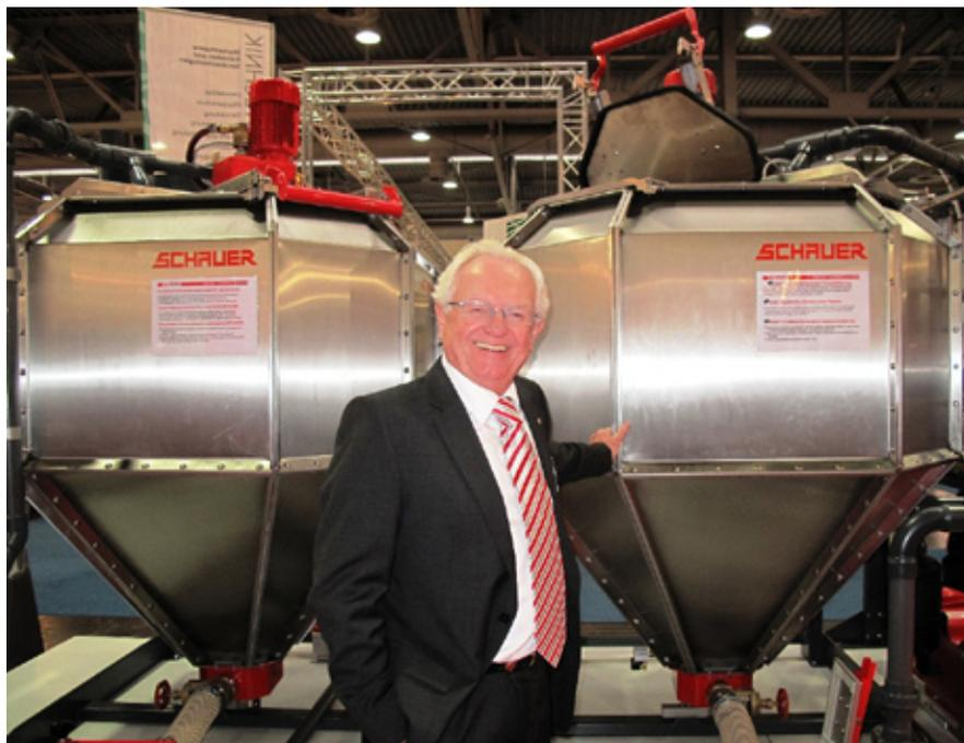
В конструкциях бункеров EASY CLEAN полностью отсутствуют прямые углы
