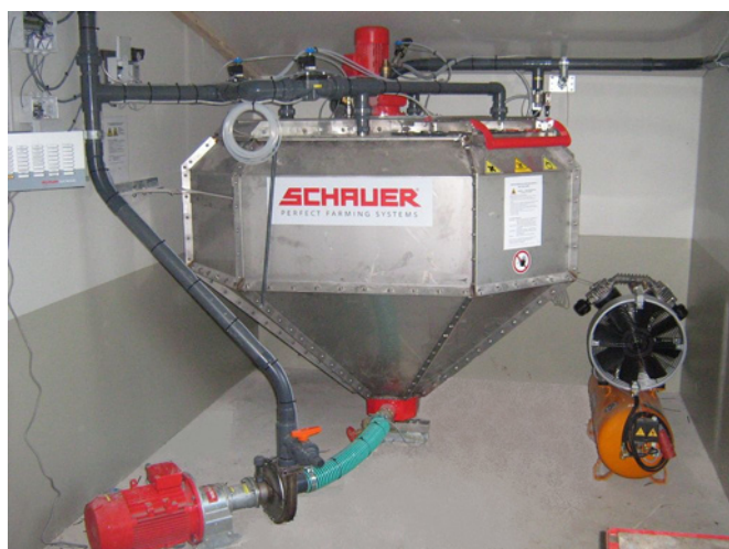
Бункеры для жидкого кормления компании Schauer не имеют прямых углов, поэтому остатки корма легко удаляются оттуда без лишнего расхода воды
