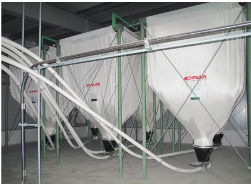
Матерчатые бункеры для измельченного зерна связаны гибкими шнеками с установкой Spotmix
