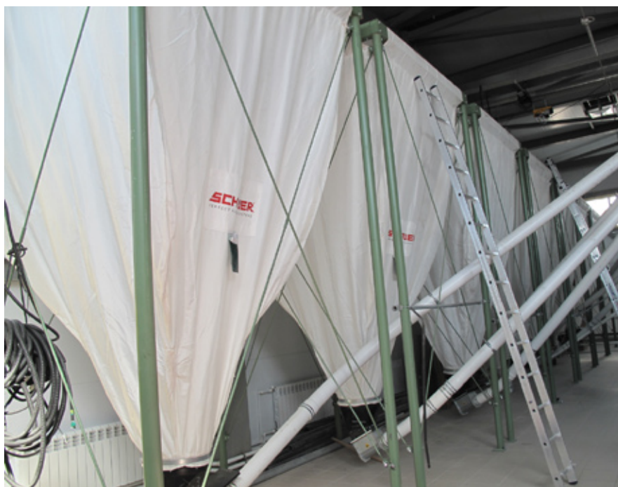
Из матерчатых бункеров размолотое зерно подается в установку Spotmix, которая готовит для каждого кормового места точную порцию каши по определенному рецепту
