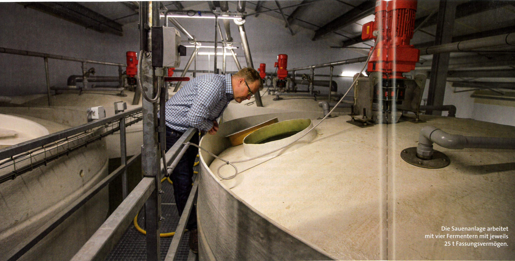
Für einen sicheren Fermentationsprozess setzt der Betrieb Starterkulturen zu. Diese werden automatisch in die Fermenter gepumpt.
