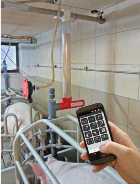
Система дозування сухого корму для свиноматок MamaDos
