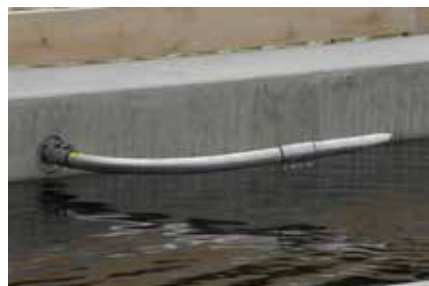
Труба выброса корма, монтируется на стену, снимается без использования инструментов
